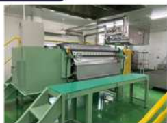
ダブルドラムドライヤー ペースト状の野菜等をフレーク状に乾燥できる
