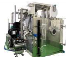
真空凍結乾燥機 食品を凍結した後、真空下で水分を昇華させ乾燥できる（フリーズドライ）
