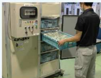
○定温蒸気処理装置
