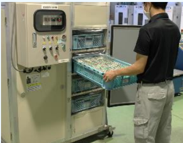
○定温蒸気処理装置
